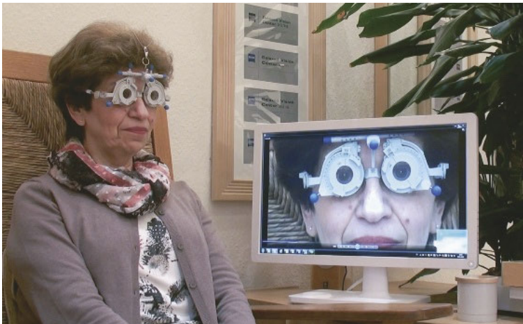
Abb. 3: Sitzkontrolle der Messbrille mit einer Kamera
